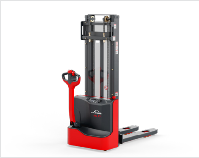
Langer Deichselarm und Notaus-Schalter
